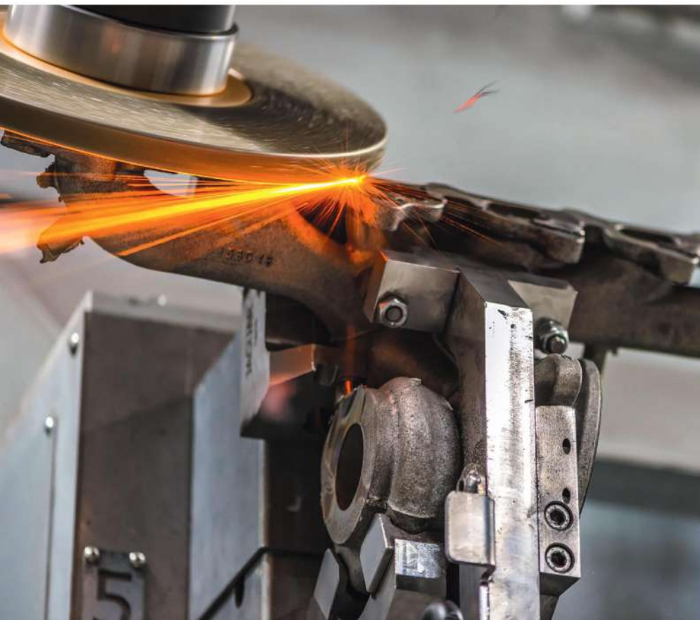
1 Die automatisierte Nachbearbeitung von Gussteilen übernimmt bei IDS Casting ein besonders geschützter Roboter aus der Fortec-Reihe | © Kuka
