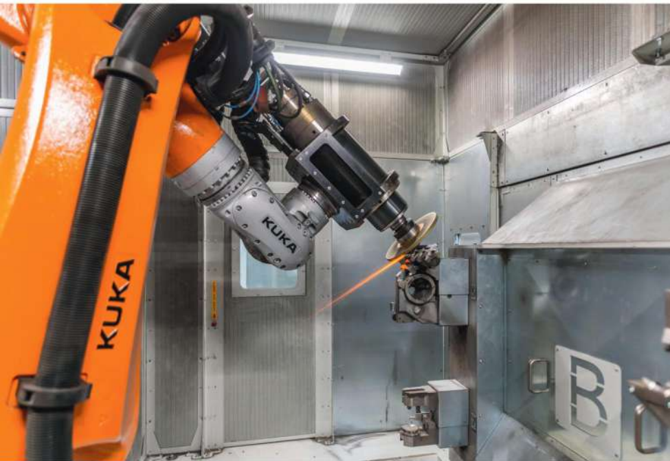
2 Der Schutz vor Stäuben und Spänen ist dank der Foundry-Ausführung der Roboter, die mit hitze-, korrosions- und säurebeständigen Lackierung sowie extra Dichtungen aufwartet, gut gegeben (© Kuka)
